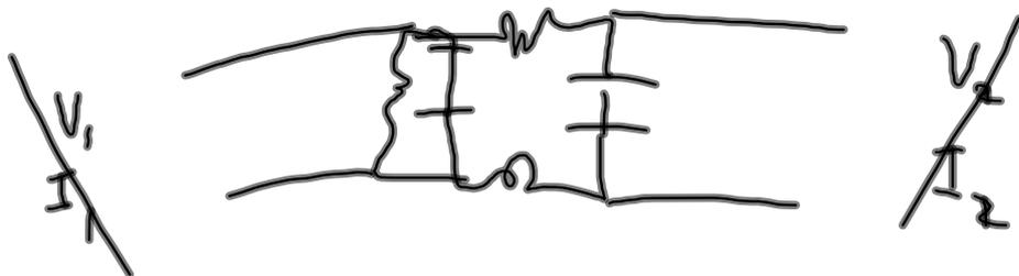
$$\begin{bmatrix} \text{in} \\ \text{refl} \end{bmatrix} = \mathcal{S} \begin{bmatrix} \text{trans} \\ \text{refl} \end{bmatrix}$$
